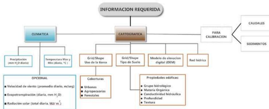
Figura A20. Insumos necesarios para la modelación hidrológica con SWAT
