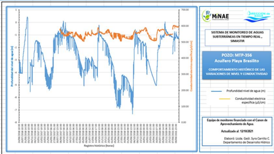
Fig. 7. Comportamiento horario de las variaciones de los registros de nivel y conductividad eléctrica registrados por Simastir, en el pozo MTP-356 (Asada Brasilito 2 “Terciopelo”).
