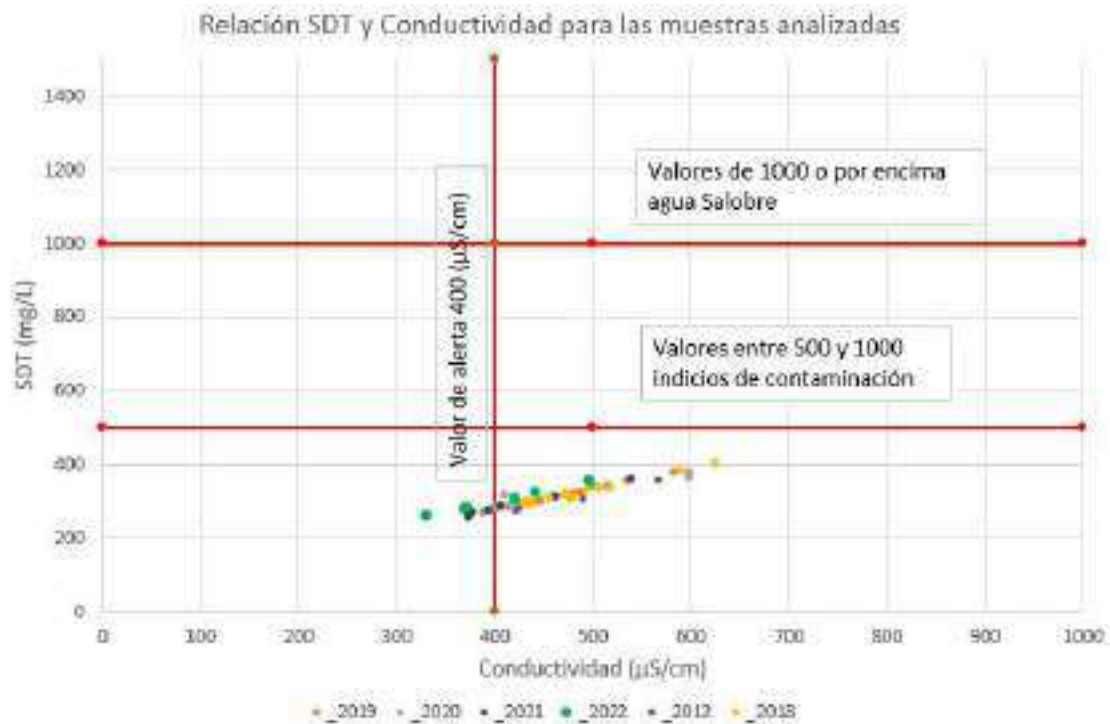
Figura 80: Diagrama relación de concentración de sólidos disueltos totales y conductividad eléctrica para todas las muestras analizadas.
