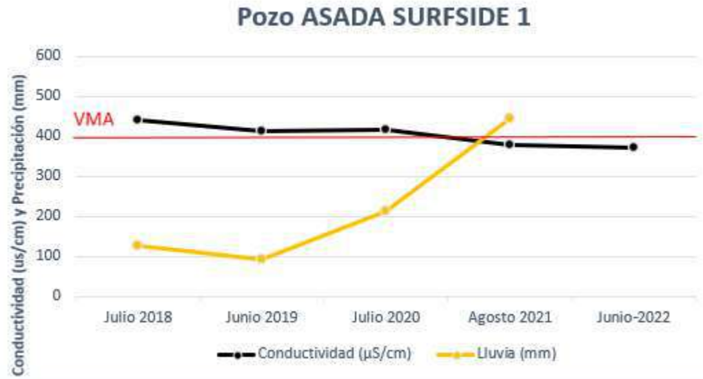
Figura 74: Análisis de conductividad en el tiempo de pozo ASADA Surfside 1. Subcuenca Cucaracha.
