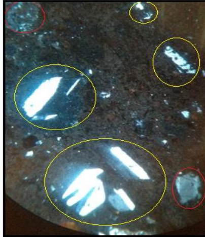
Foto 16. Muestra DD9-1 NX utilizando 4x zoom, plagioclasas dentro de círculos amarillos muy abundantes en esta roca y líticos dentro de círculos rojos.
