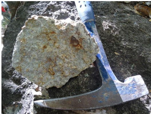
Foto 31. Muestra de toba gris lítica con cuarzo de la Unidad Punta de Palo
