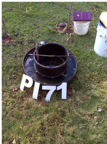
Foto 61. Prueba de infiltración llevada a cabo en la zona de Cañas
