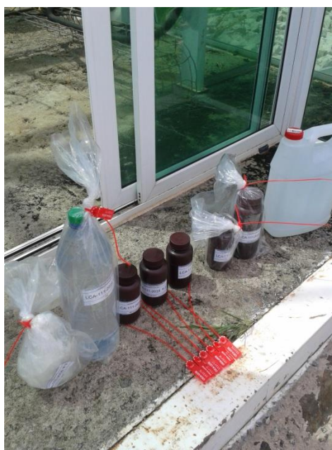
Foto 74. Tipo de embase y etiquetas usadas para identificar las muestras en el campo
