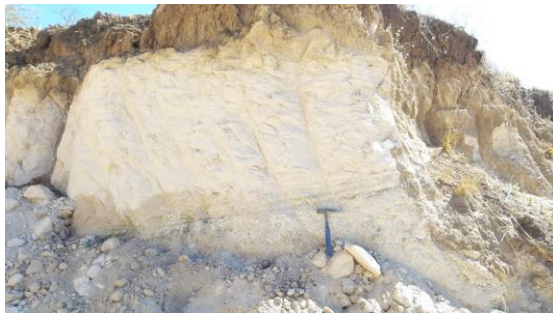
Foto 12. Toba de ceniza media sobreyaciendo capa de lapillita de poméz.
