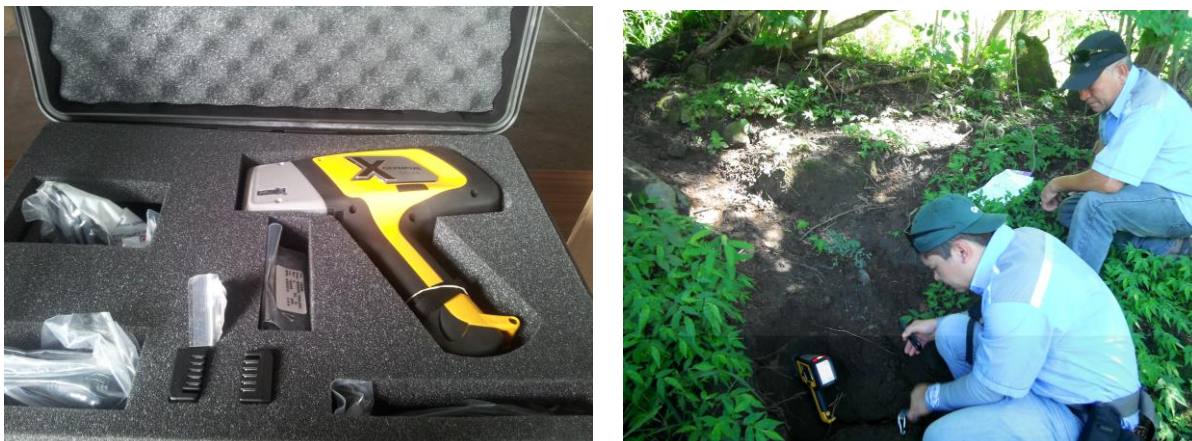
Foto 72. Equipo Portátil de Fluorescencia de Rayos “X” y su uso en el campo
