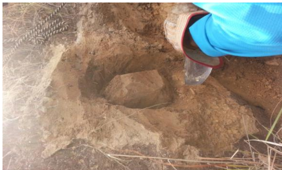
Foto 66. Extracción de muestra inalterada.
