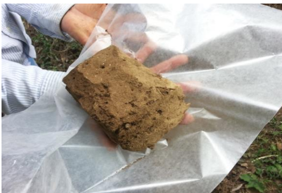
Foto 67. Protección de muestra inalterada.
