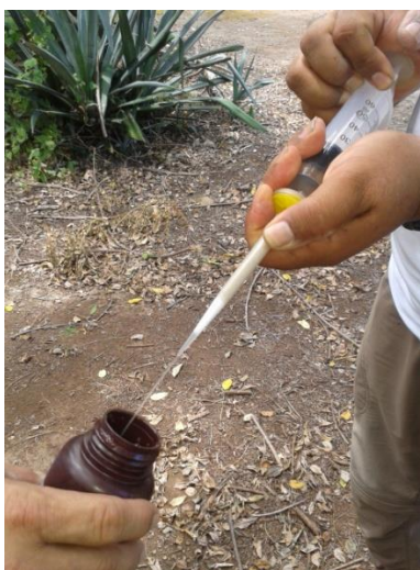
Foto 73 Muestreo de agua usando filtros descartables para especiación del arsénico
