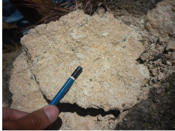
Foto 22. Toba parda rosada con pómez centimétricos rica en matriz cinerítica de grano grueso.
