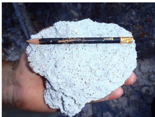
Foto 27. Muestra del flujo de pómez con biotita y anfíboles.
