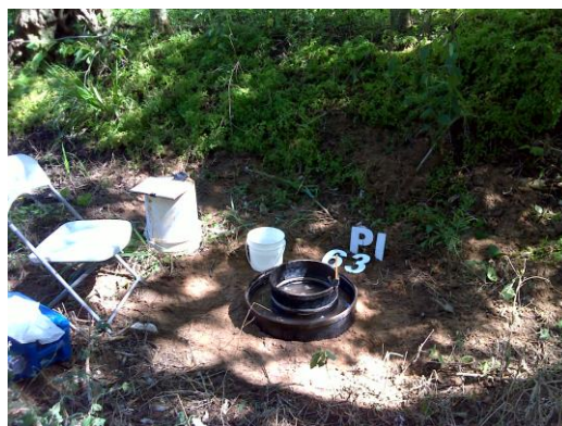
Foto 62. Prueba de infiltración llevada a cabo en la zona de Bagaces.
