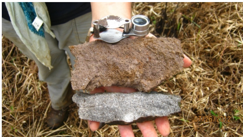
Figura 11 Muestra de mano recolectada para su análisis posterior por medio de sección delgada, DRX y FRX.
